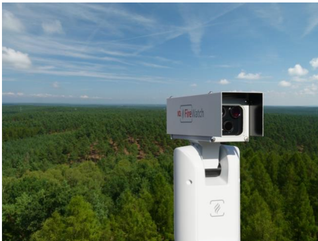
Die multispektrale Sensoreinheit des AWFS IQ FireWatch
